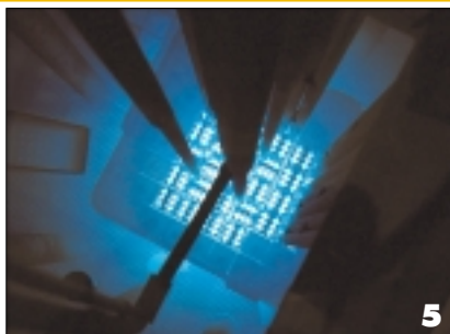
5. A Budapesti Műszaki és Gazdaságtudományi Egyetem atomreaktorának radioaktív fűtőelemeit körülvevő vízben kékesen derengő Cserenkov-sugárzás ( http://www.reak.bme.hu )
