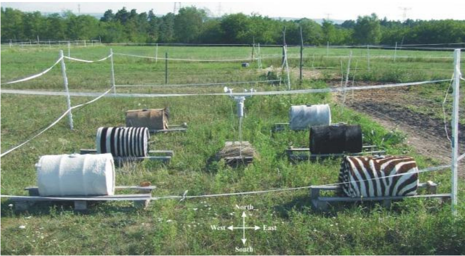
A 2017 nyarán folyó hordós terepkísérelt elrendezése 6 különböző állatbőrrel bevont, vízzel telt fémhordóval, melyek maghőmérsékletét folyamatosan, 5 percenként mérték, egy meteorológiai állomás pedig egyfolytában regisztrálta a meteorológiai paramétereket. FORRÁS: ELTE
