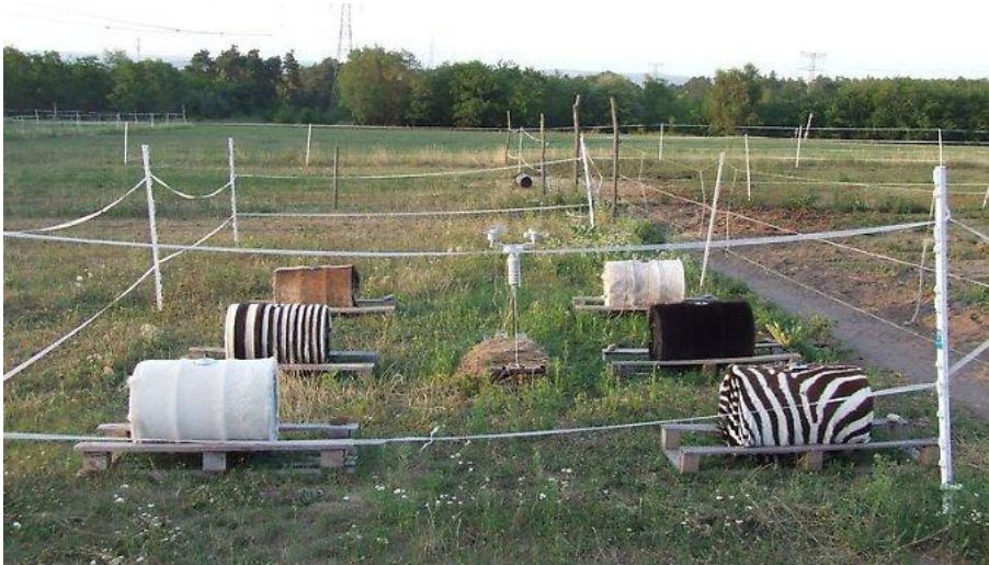
Mit verschiedenen Fellen überzogene Metallfässer mit Wasser auf einem Acker. Die Fässer stellten die Wissenschaftler über mehrere Tage in die pralle Sonne in Ungarn und maßen die Temperatur im Inneren. Zudem registrierte eine spezielle Kamera die Wärmeverteilung auf der Oberfläche der Fässer.
