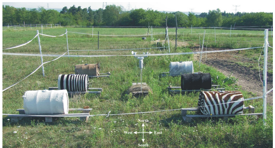
1. ábra: A 2017 nyarán folyó hordós terepkísérlet elrendezése 6 különböző állatbőrrel bevont, vízzel telt fémhordóval, melyek maghőmérsékletét folyamatosan, 5 percenként mérték, egy meteorológiai állomás pedig egyfolytában regisztrálta a meteorológiai paramétereiket.
