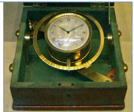
A XVIII. századtól a helymeghatározás alapvető eszközei a Nap horizonttól való szögtávolságának mérésére használt szextáns (balra), valamint a földrajzi hosszúsági fokok megállapításához szükséges, pontos greenwichi időt mutató fedélzeti kronométer (jobbra) voltak (FORRÁS: HTTP://NEMZETIKONYVTAR.BLOG.HU ÉS ROYAL NAUTICAL MUSEUM, GREENWICH)
