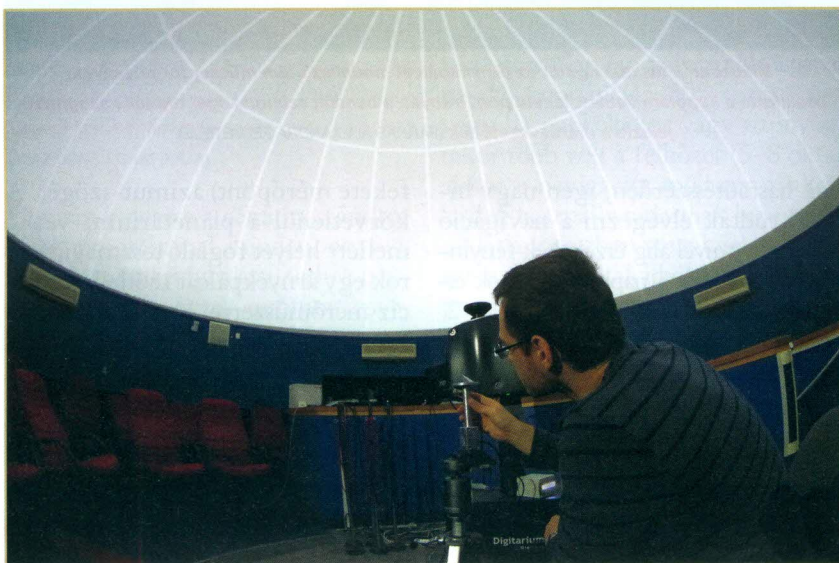
Egy tesztnavigator a Napot képviselő kivetített fekete pont azimutuszögét méri az ELTE digitális planetáriumában (FARKAS ALEXANDRA FELVÉTELE)
