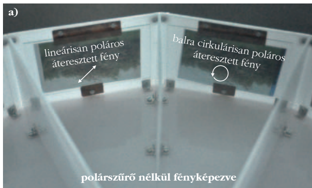
7. ábra. Az 5. kísérletben használt, itt fejtetőre állított testdoboz egy főszejtora polárszűrő nélkül (a) és lineáris polárszűrőn át fényképezve, mely polárszűrő áteresztési irányát fekete kettősfejú nyíl mutatja. A testdoboz minden főszejtorának két ablaka közül az egyik teljesen lineárisan poláros fényt (TLP) eresztett át (a polarizációirány 45^\circ volt a vízszinteshez képest, amit duplavégű fehér nyíl jelez), a másik ablak pedig BCP-fényt.
