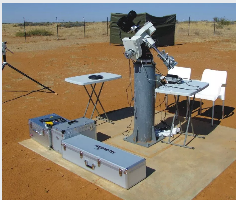
3. ábra: A magyar hordozható képkalkotó polariméteres távcső az Isabis Asztrófarm egyik teleszkópállványán (Horváth Gábor fényképe)
